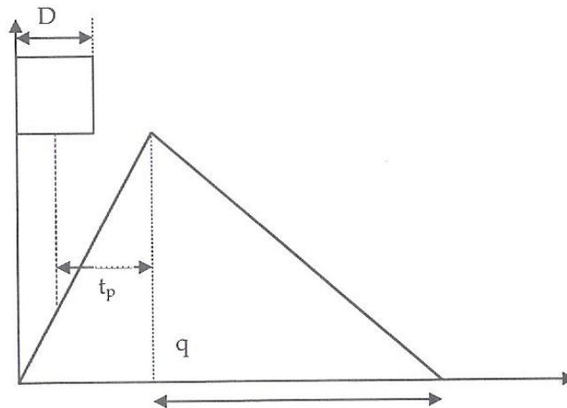
**Figura 34 - Hidrograma triangular utilizando o Método SCS (1975)**
